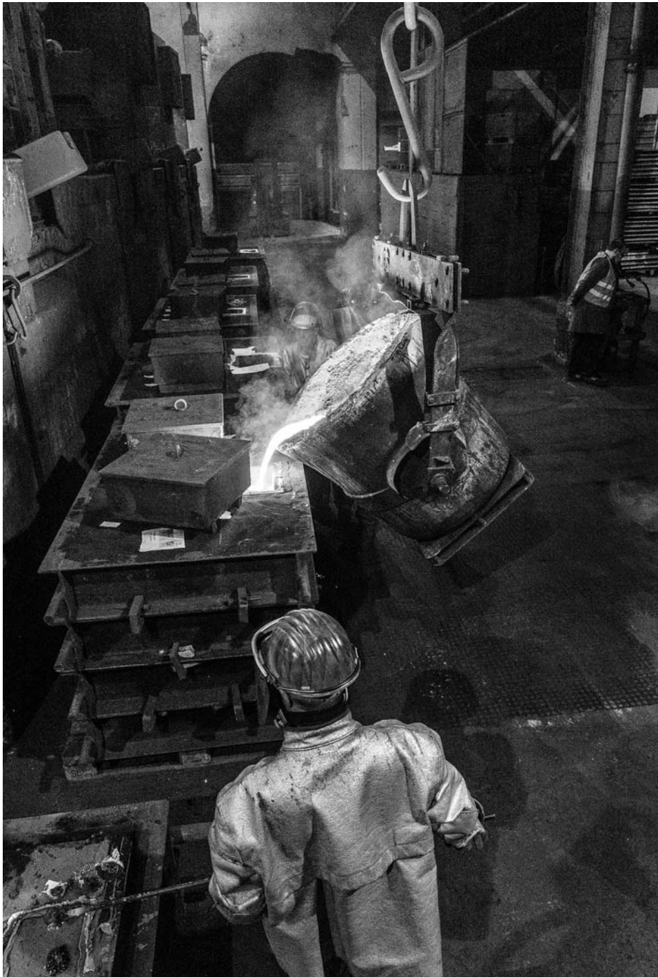
Fonte des candélabres à la fonderie von Roll à Choindez.
